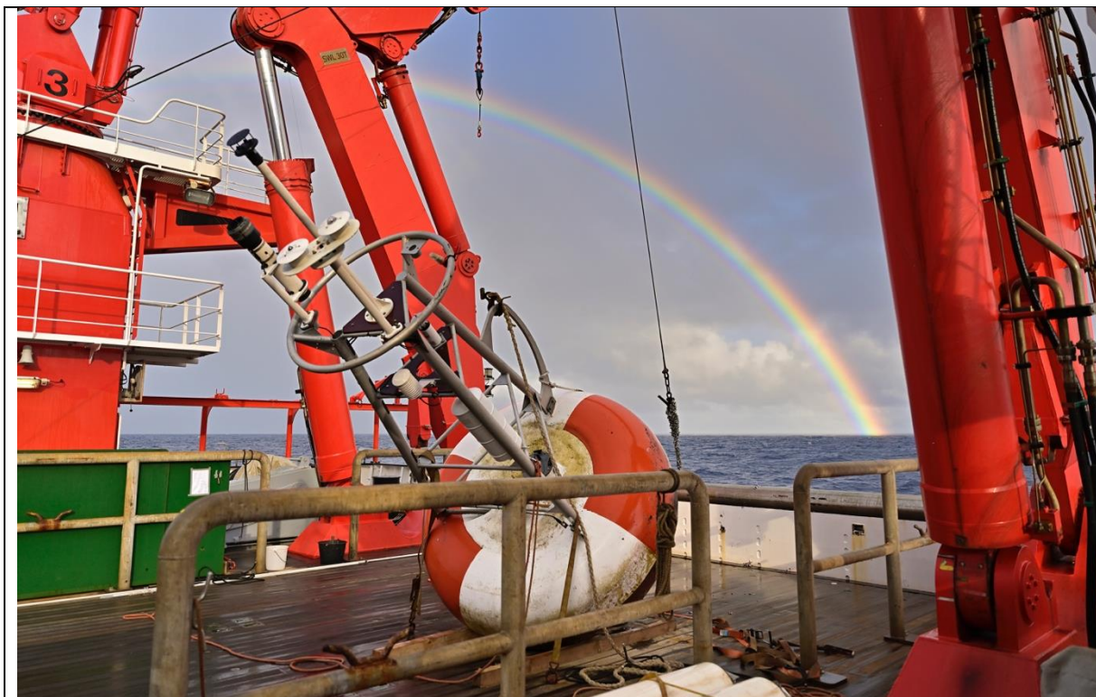
Abbildung 1: Kopfboje des PIRATA-Messsystems auf dem Achterdeck des FS SONNE (keine Fotomontage). Foto: Solvin Zankl
